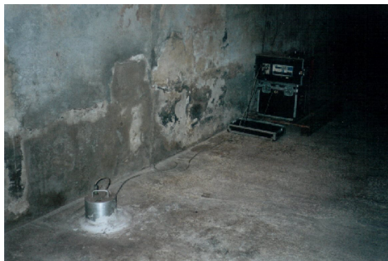
Figura 9: Stazione mobile digitale Lennartz Mars88-FD con sensore Mark L4c-3D installata all'interno della galleria
